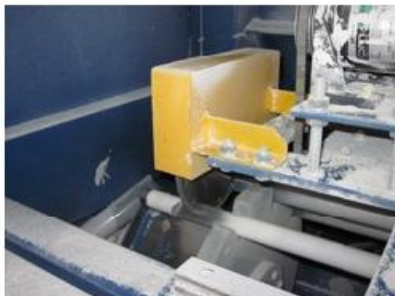
(蛍光管)口金とガラスの切断
