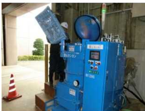
スプレー缶破砕機に投入
