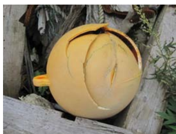
割れた FRP ブイ
