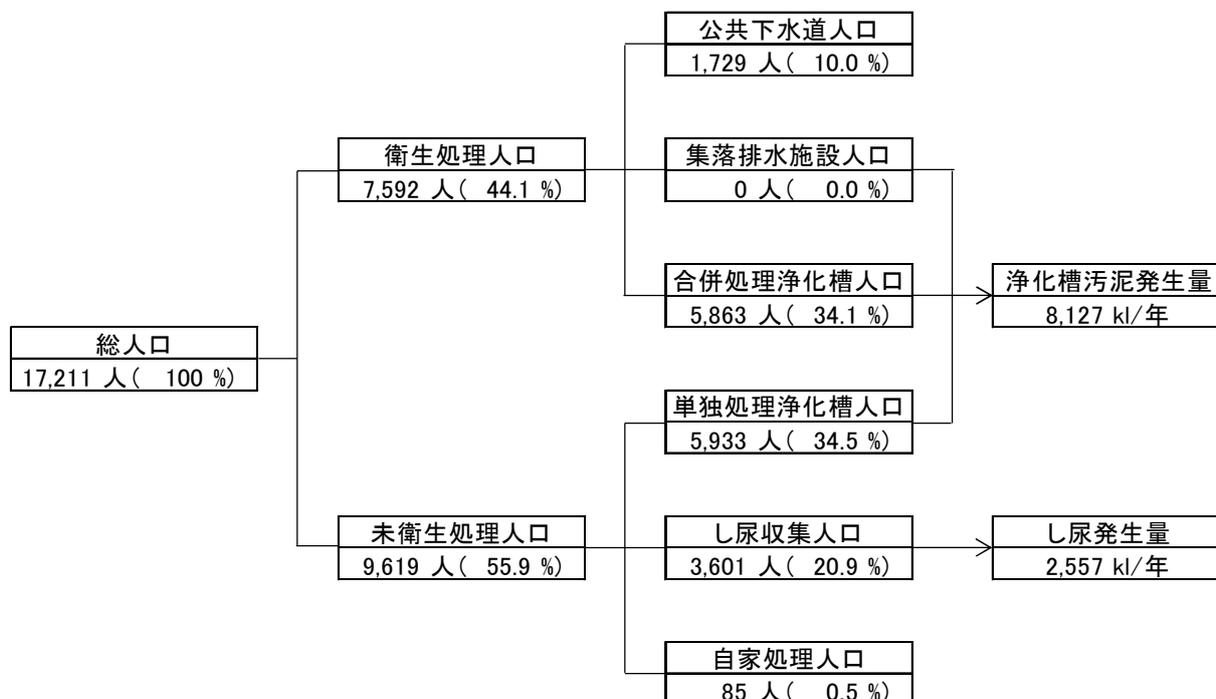
図 2-10 目標達成時の生活排水処理状況フロー（平成 31 年度）
