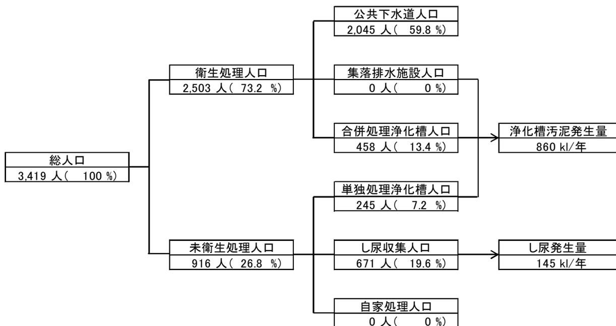
図 2 - 6 太地町の生活排水の処理状況フロー（平成 23 年度）
