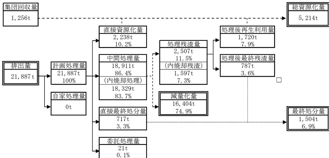
図3—3 知立市 目標達成時の一般廃棄物の処理状況フロー(平成28年度)
