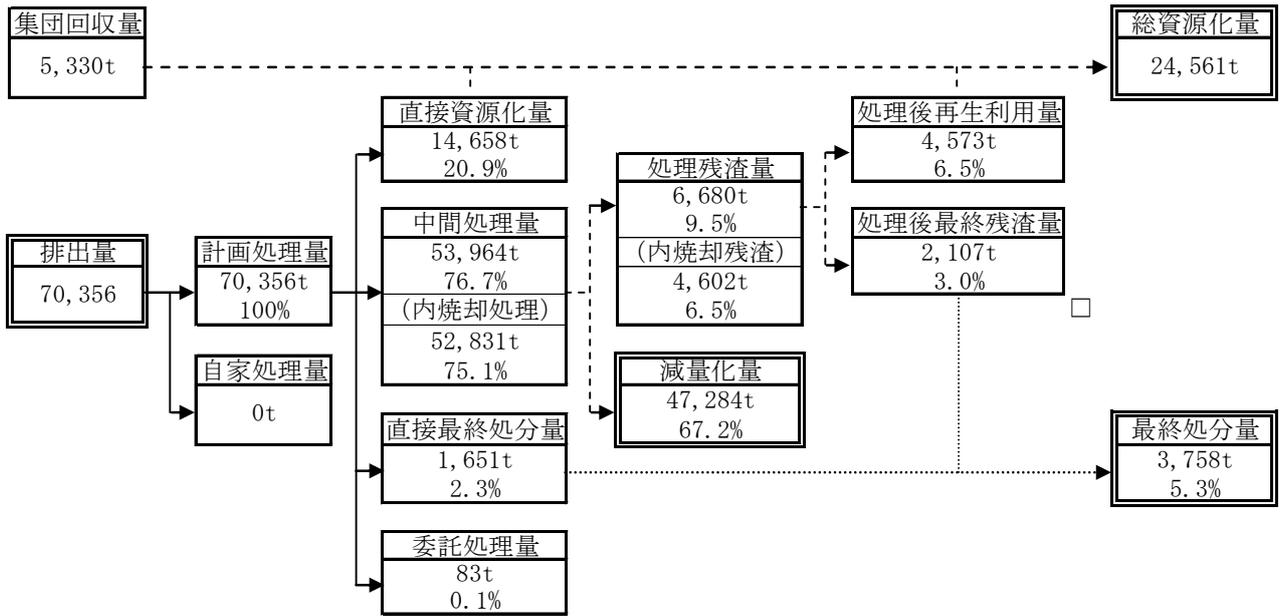
図3—1 刈谷知立地域 目標達成時の一般廃棄物の処理状況フロー(平成28年度)
