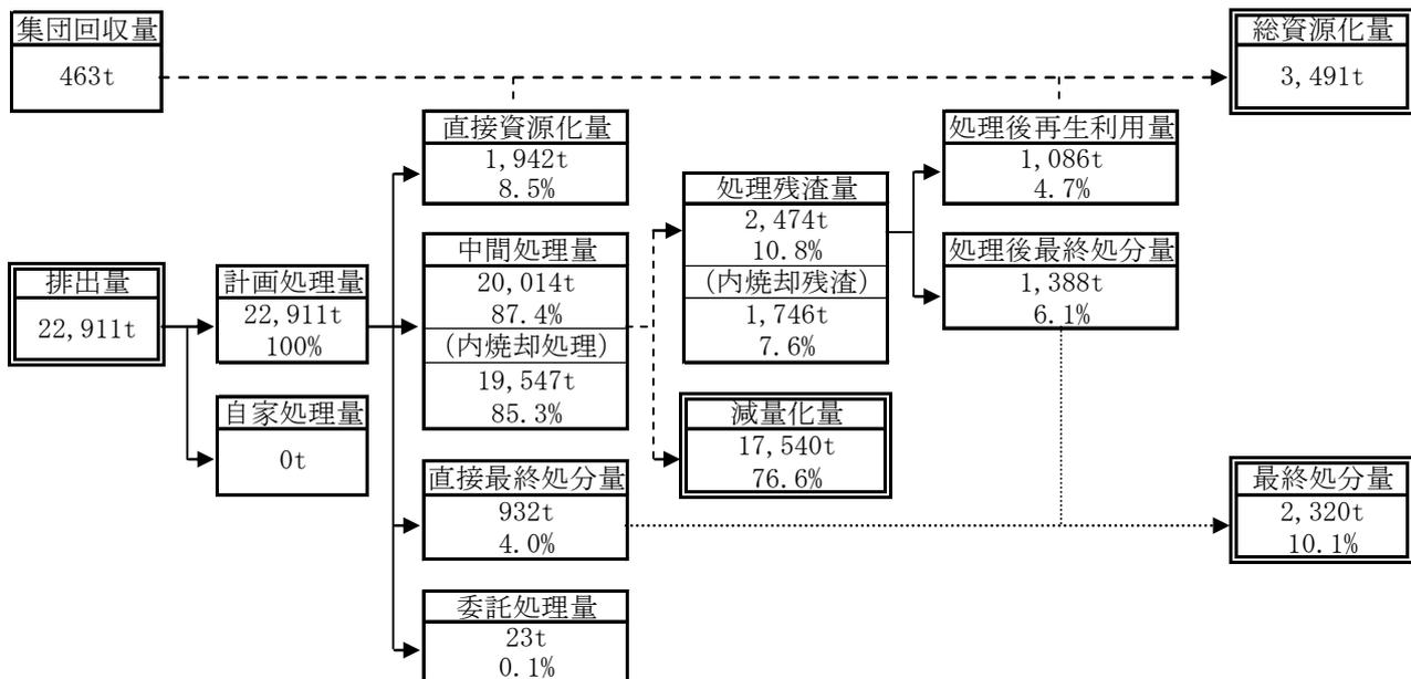
図 1—3 知立市 一般廃棄物の処理状況フロー(平成 21 年度)
