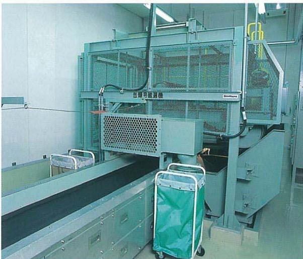
■磁選機(電磁・永磁併用吊下式)
