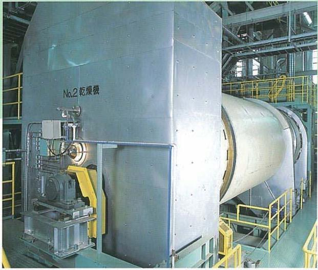
■乾燥機(直接熱風式ロータリーキルン方式)
