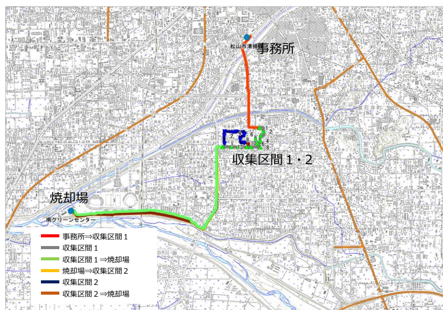
図 4.5(1)-1 収集車両の走行ルートの事例 (1) 市街地：松山市の事例 2か所の収集区間で収集作業を行い、1つ目の収集区間のごみを 焼却所で廃棄してから、2つ目の収集区間で収集作業を実施する
