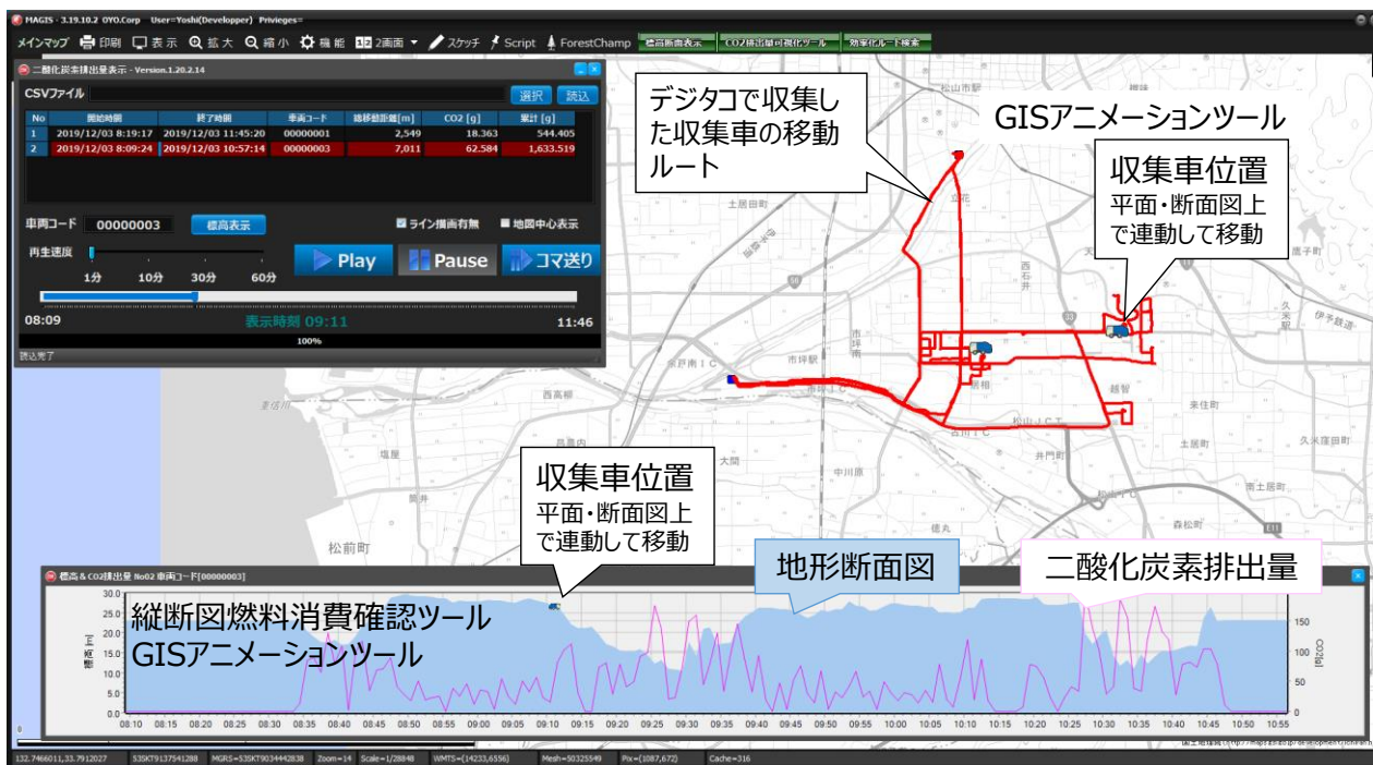
図 4.3(1)-2 車両位置確認ツールのイメージ図 「燃料消費量確認ツール」と連動する機能
