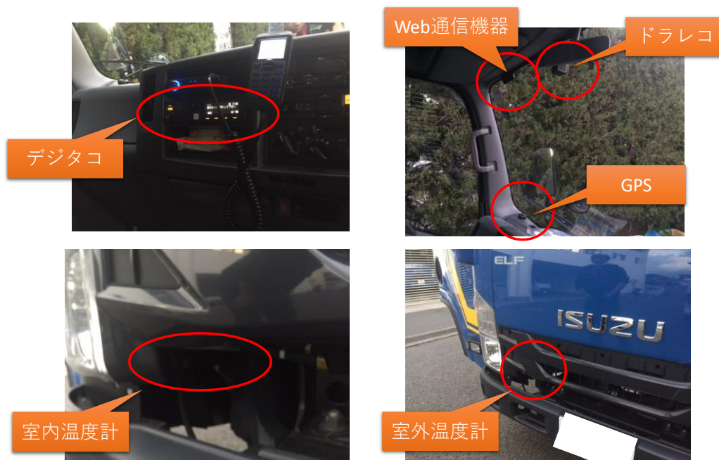
図 4.2(1)-3 デジタルタコグラフの設置状況
