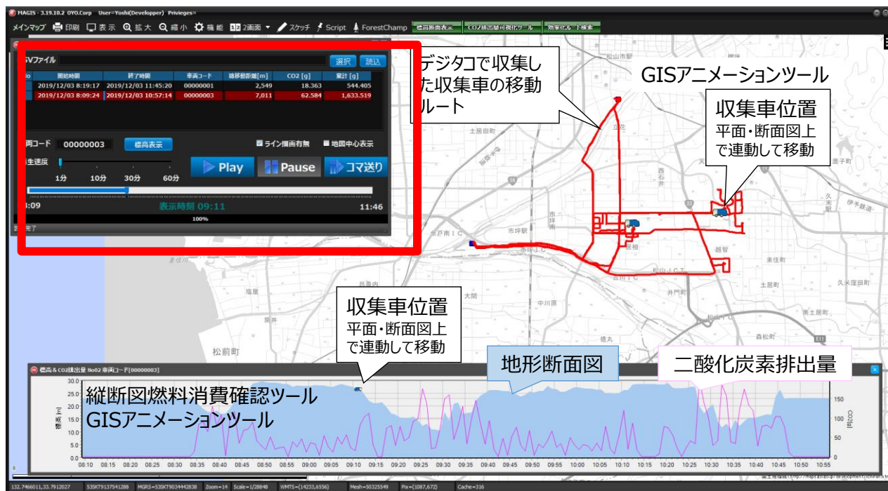
図 4.3(2)-2 燃料消費量確認ツールのイメージ図 「車両位置確認ツール」と連動する機能
