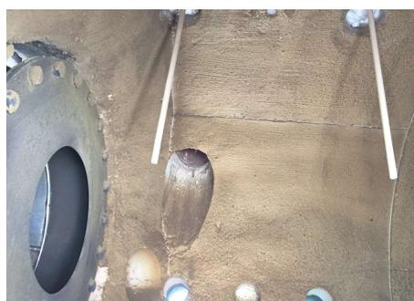
図 4. 1. 3-6 熱電対設置位置移動後(試験後)
