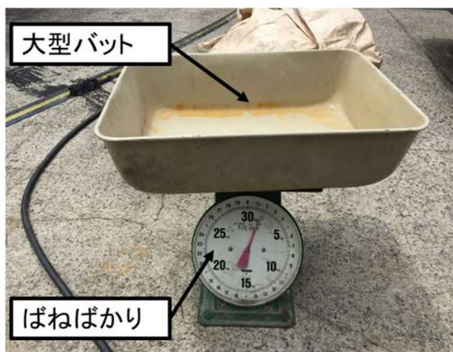
図 1.6.2-2 灰重量測定機器
