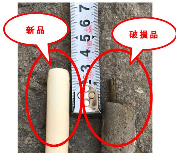
図 4.1.3-3 熱電対先端破損 2
