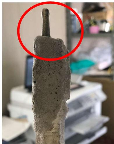
図 4.1.3-2 熱電対先端破損 1
