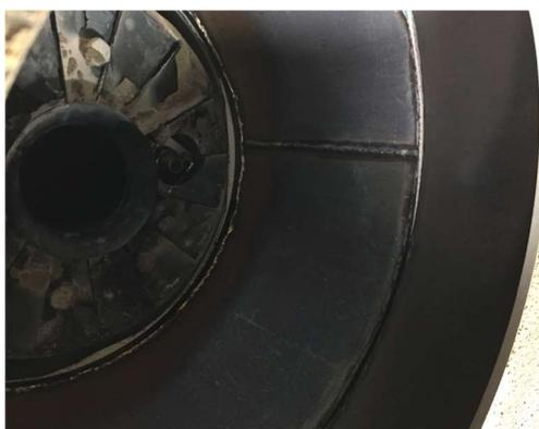
図 4.1.2-5 対策後のスロート内面(試験後)
