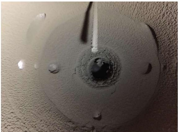
図 1.6.4-5 直投バーナ(供給量 155.0kg) 図 1.6.4-6 直投バーナ(供給量 360.0kg)
