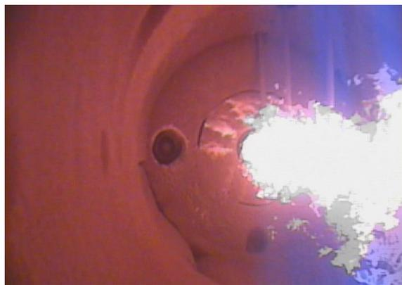
図 3.5.2-2 RUN 3 の専焼時の燃焼の様子
