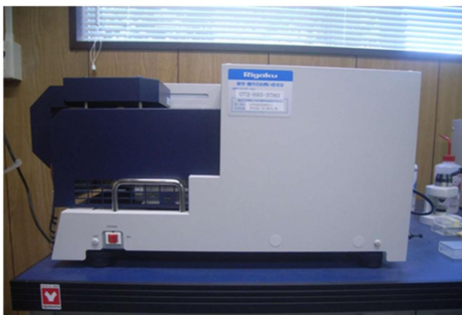
図 1.5.2-1 熱分析装置 TG-DTA(リガク製)
