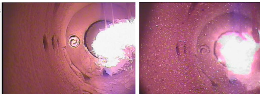
図 3.2.2-3 RUN 4 の燃焼の様子（左写真：専焼 右写真：混焼 20%）
