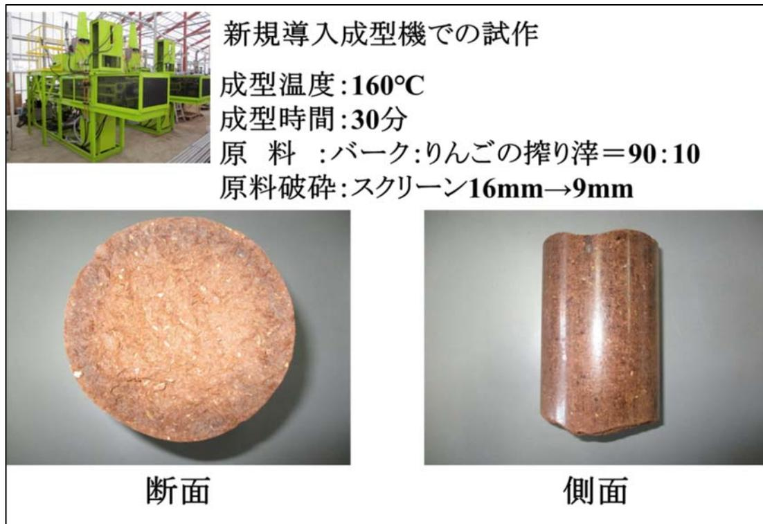
図 2-33 BIC 試作品 No. 10 外観と成型条件
