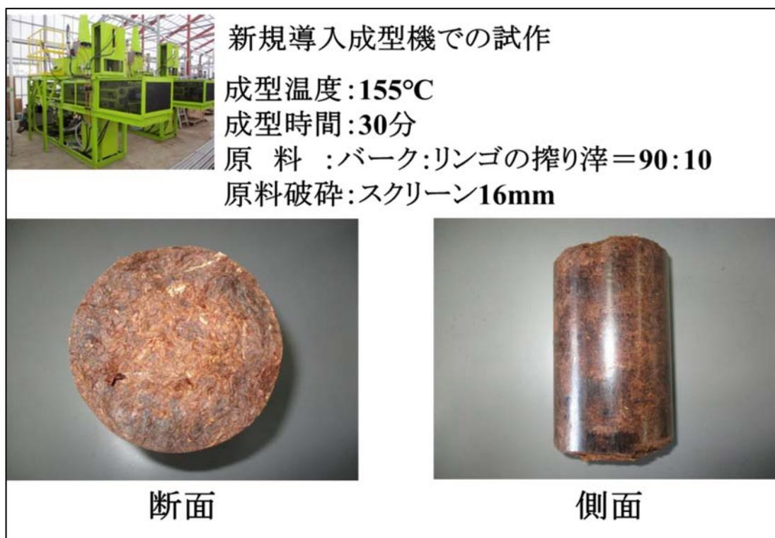
図 2-34 BIC 試作品 No. 13 外観と成型条件
