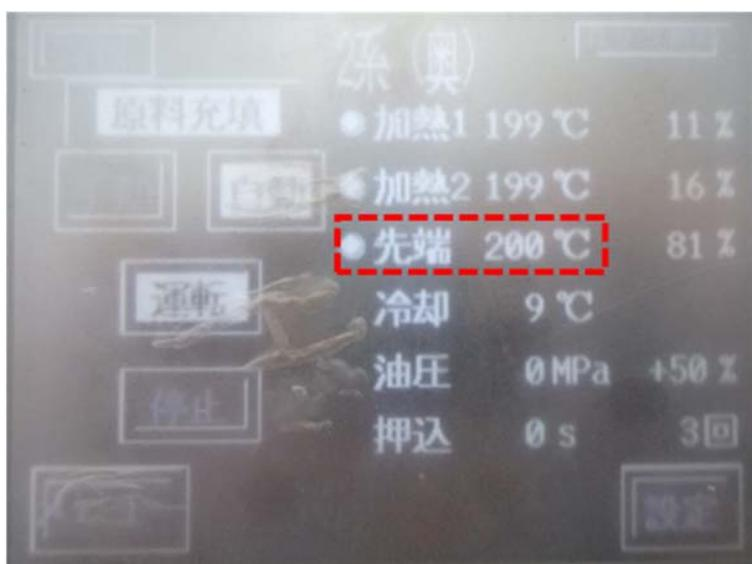
図 2-28 端面ヒータ 200℃到達時の操作パネル画面
