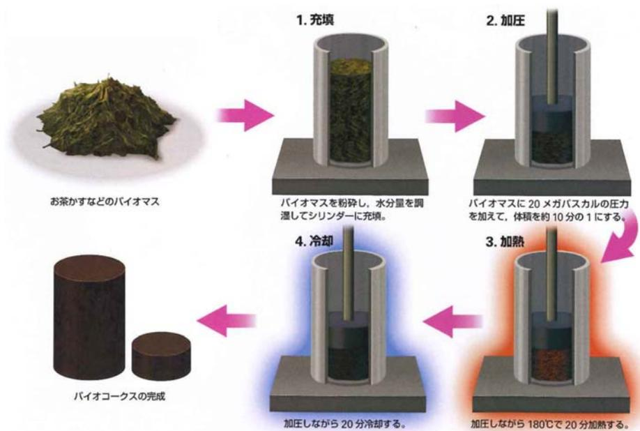
図 1- 3 BIC 製造工程
