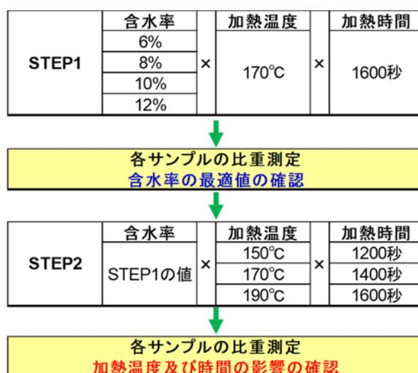
図 2-10 多原料 BIC の試作手順
