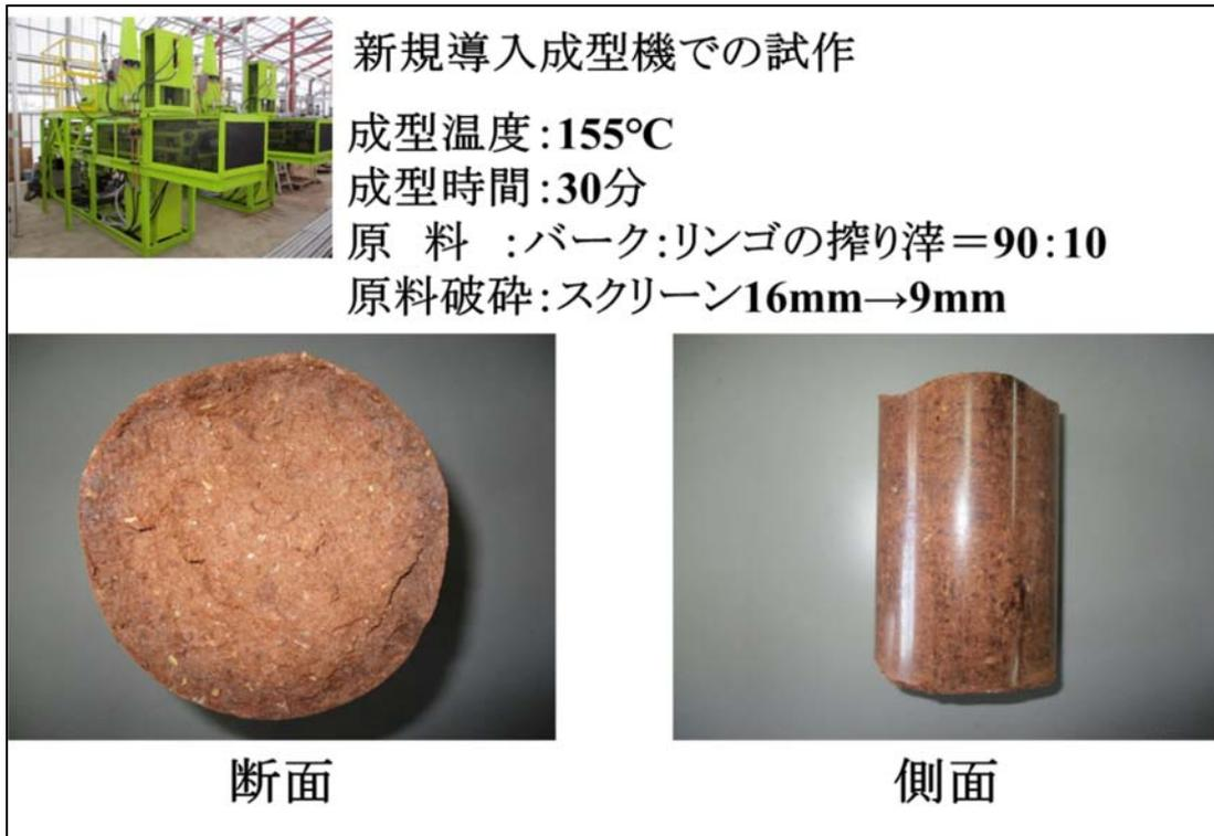
図 2-32 BIC 試作品 No. 9 外観と成型条件
