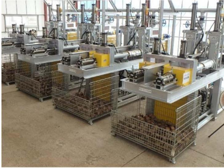
図 1-2 BIC 成型機（横型）
