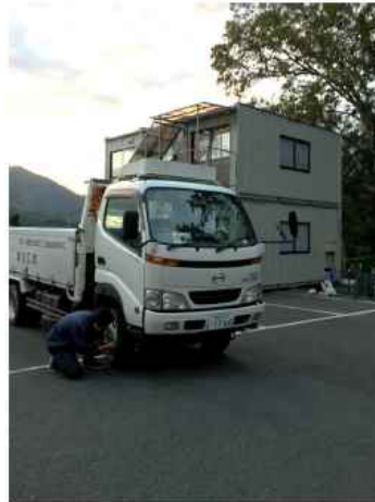
図 - 1 - 7 タイヤ空気圧センサー設置の様子
