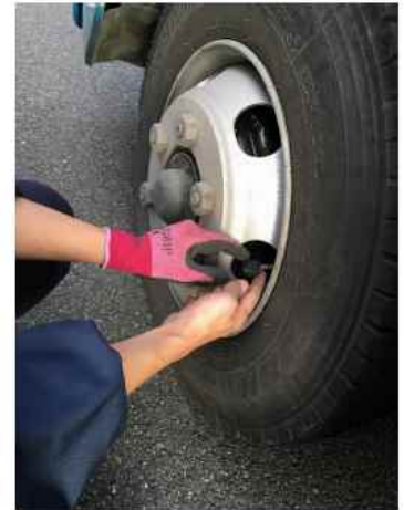
図 - 1 - 7 タイヤ空気圧センサー設置の様子
