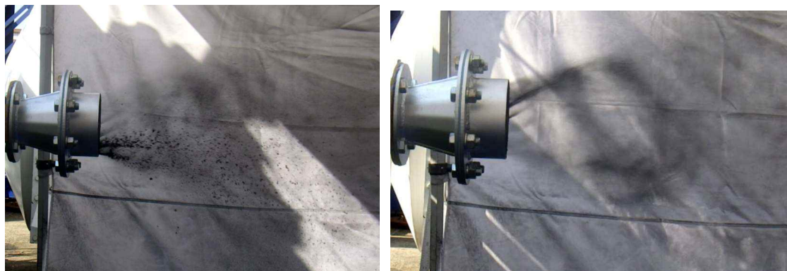
図 3.1.3-7 試験 No. 1（旋回エア無） 図 3.1.3-8 試験 No. 4（旋回エア無）
