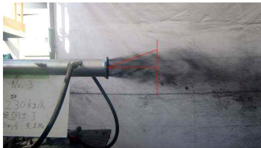
図 3.1.2-10 試験 No.3 噴射角度
