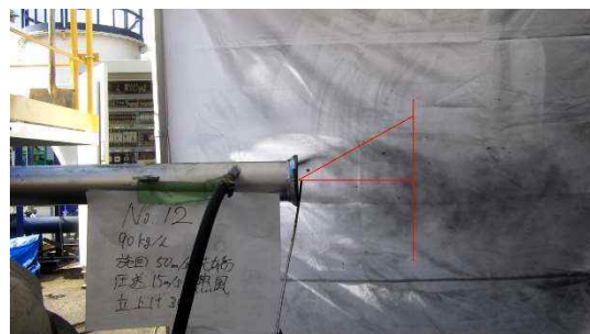
图 3.1.2-19 試驗 No.12 噴射角度
