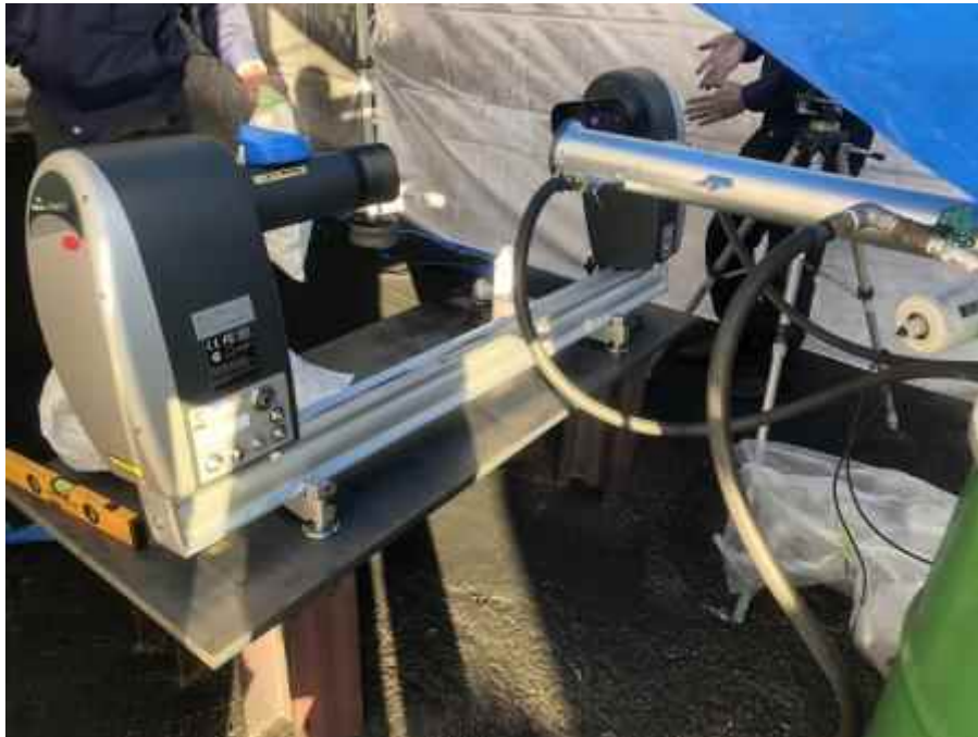
図 3.1.2-6 Spraytec デモ機外観写真
