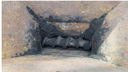
図 2.1.1-6 付着した炭化燃料写真
