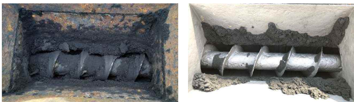
図 2.1.1-13 処理前後の付着量比較（左：処理前、右：処理後）
