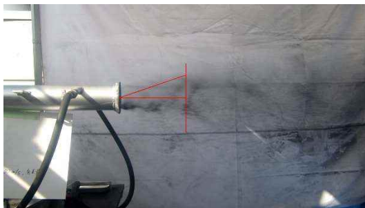
図 3.1.2-8 試験 No.1 噴射角度
