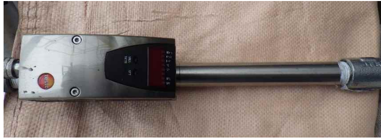
図 2.1.2-4 風量計 2 testo 製 testo6441
