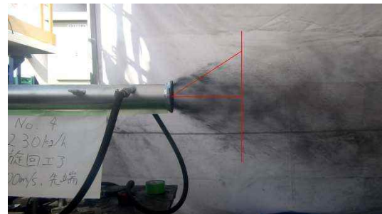
図 3.1.2-11 試験 No.4 噴射角度
