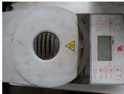
図 2.1.2-8 含水率計（オーハウス製 MB45）
