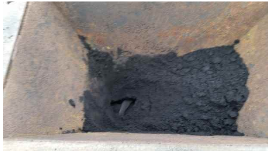
図 2.1.1-5 アーチングの様子写真
