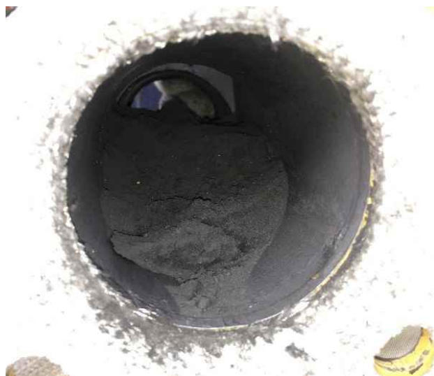
図 2.1.2-12 立ち上げ角度 45^\circ の条件における傾斜部の滞留物
