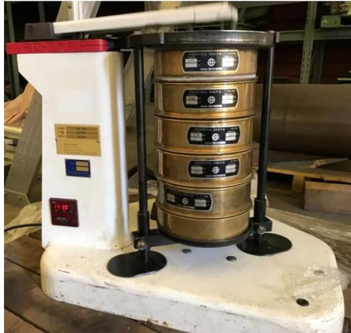
図 2.2.2-1 W.S. TYLER 社製の RX-29 ふるい振盪機
