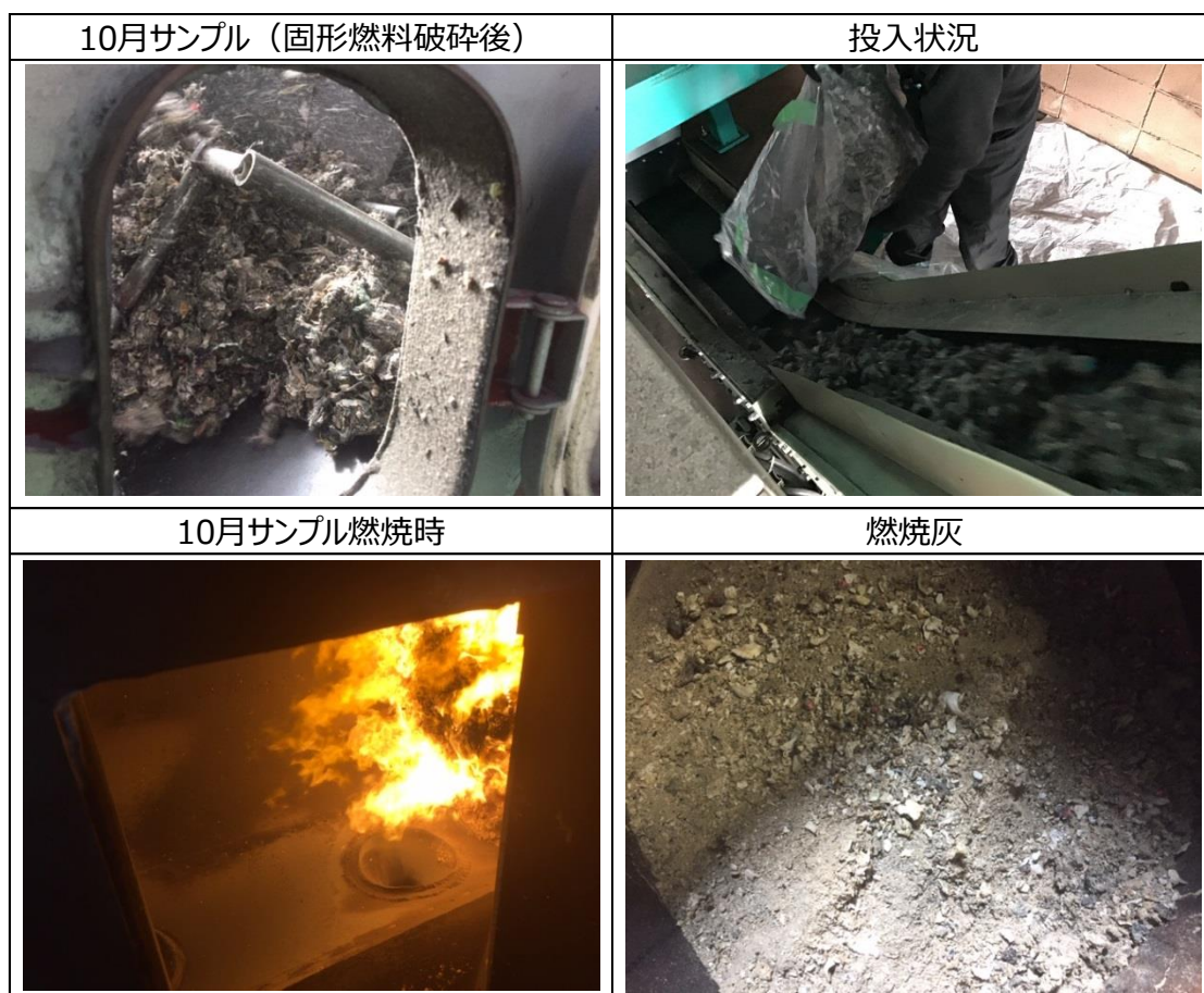
図 2.2-4 固形燃料燃焼試験風景
