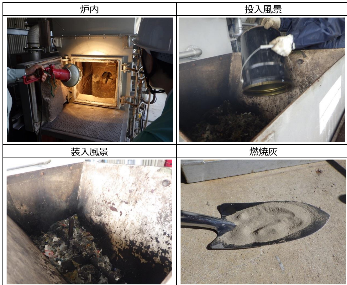
図 2.2-6 フラフ燃料燃焼試験風景
