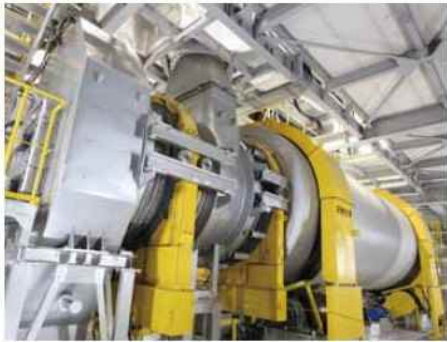
炭化炉 ごみを温めて混ぜながら約1時間かけてじっくり炭化物にします。
