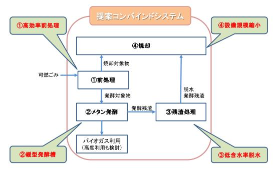
図 II-4 メタンガス化+焼却コンバインドシステムの中小廃棄物処理施設への適用性向上に係る 検証事業概要
