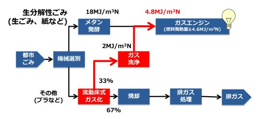
図Ⅱ-6 流動床ガス化とメタン発酵のコンバインドプロセスの要素技術検証の概要 (ヒアリング資料より)
