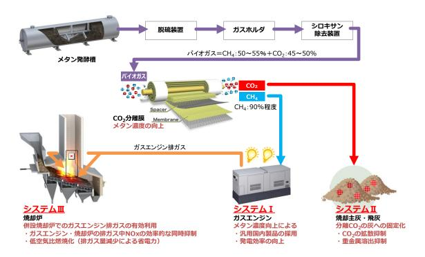
図Ⅱ-3 CO<sub>2</sub>分離膜を適用した次世代低炭素型高効率バイオガス発電システム およびコンバインドシステムの検証事業概要 (ヒアリング資料より)
