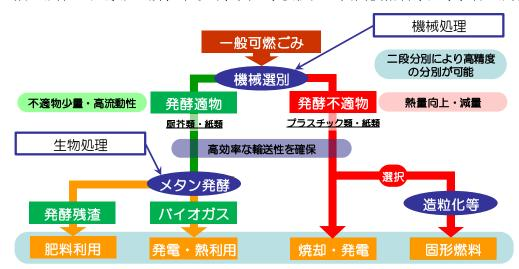
図 II-5 機械選別を用いたメタン発酵処理システムによる中小規模廃棄物処理施設での 再資源化・エネルギー化方法の評価・検証概要 (ヒアリング資料より)
