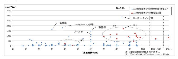
図 I-26 100t/日未満の焼却施設におけるエネルギー回収状況
