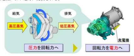
スクリュー式小型蒸気発電機の原理
