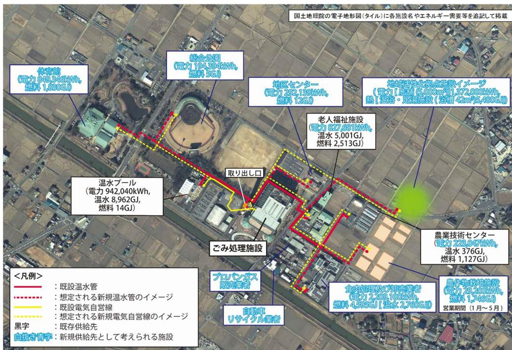
図 4 - 2 電気・熱供給先候補の位置、需要量および自営線・熱導管の敷設イメージ
