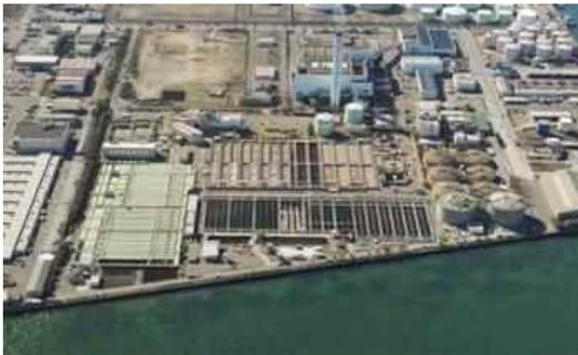
日明浄化センターは、合流式として、昭和 45 年 4 月に完成し運転を開始した。現在の処理能力は 263,000m<sup>3</sup>/日で、小倉北区・戸畑区と小倉南区・八幡東区の一部の下水を活性汚泥法により処理し洞海湾湾口部に放流している。
