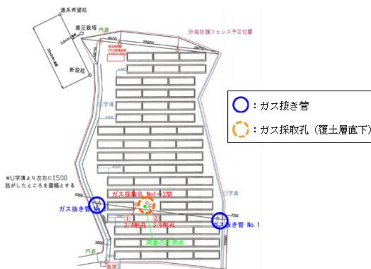
図 2.4.1-3 調査対象処分場における試料採取地点
