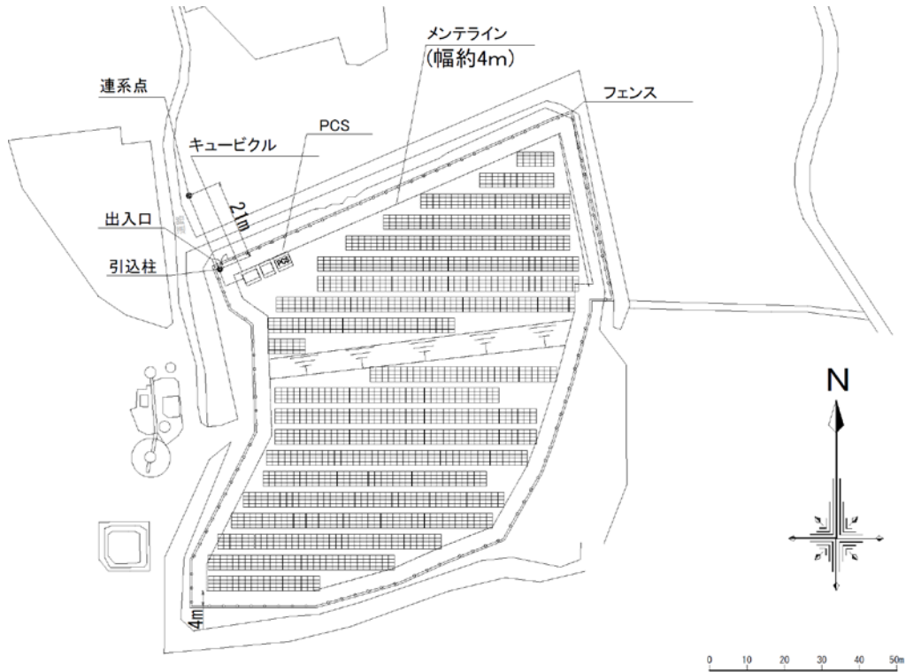
図 3-2 太陽光発電設備の導入位置
