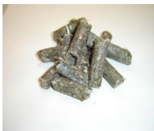
写真 I-4-(2)-2 汎用 RDF 径 15mm×長さ 30mm
