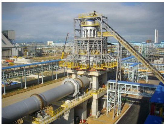
写真 I-4-(2)-1 石灰石焼成キルン炉
