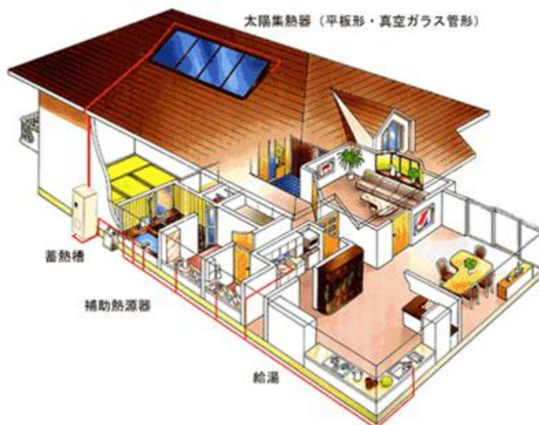
図 4-2 強制循環式の太陽熱利用システムの構造 出所) 一般社団法人ソーラーシステム振興協会ウェブサイト 21
