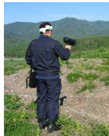
図4.8 散乱光型レーザーメタン計 (国立環境研究所撮影)
