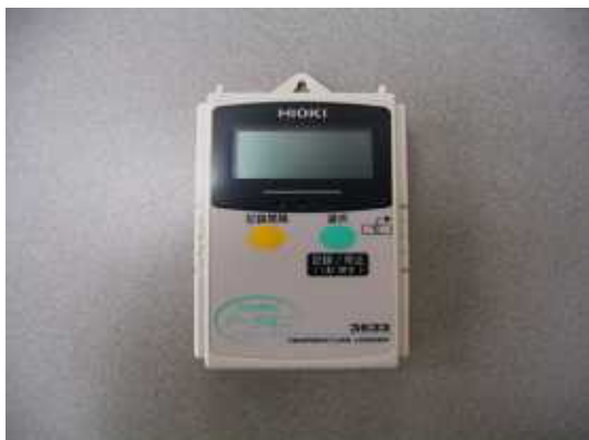
図 3.2.18 使用温度ロガーと温度ロガー設置状況
