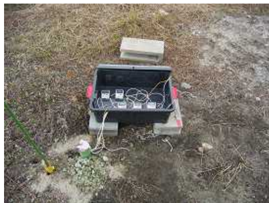
図 3.2.18 使用温度ロガーと温度ロガー設置状況
