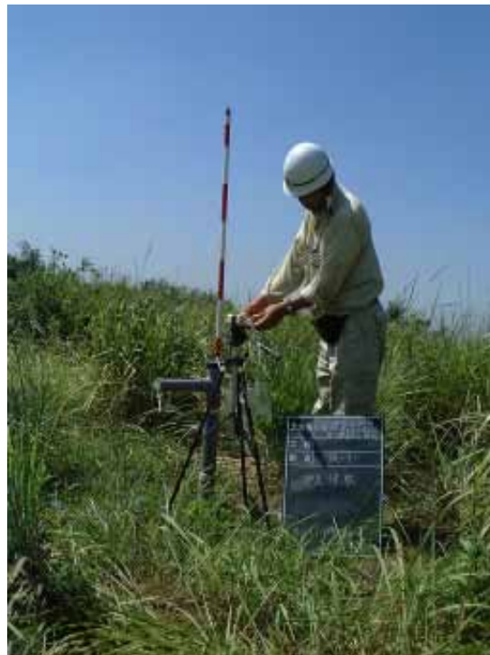
図 2-3 観測井戸の孔内ガス採取状況
