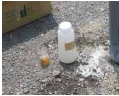
図 2-2 採水された保有水等（左が DO 測定用、右がその他分析項目）
