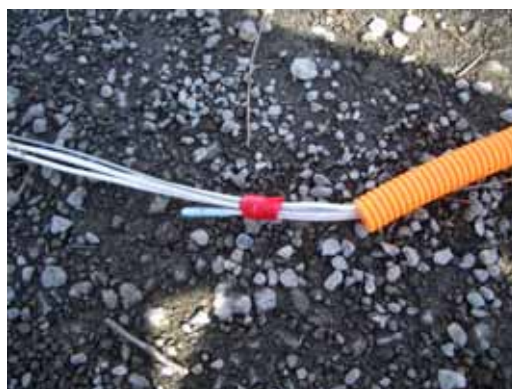
図 2-14 孔内温度測定に使用した温度計 9631
