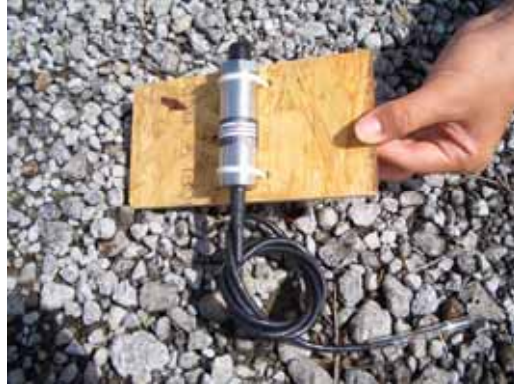
図 2-15 気象情報として大気圧測定に使用した絶対圧計 US10000
