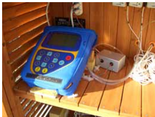
図 2-12 孔内ガス濃度連続測定に使用した GA2000Plus
