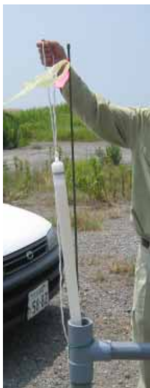
図 2-1 保有水等の採取に利用した採水器
