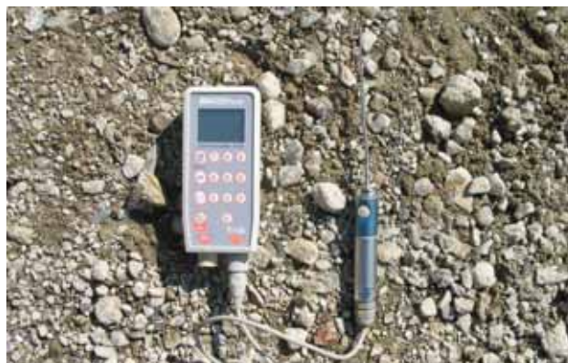
図 2-9 地表面温度の測定
