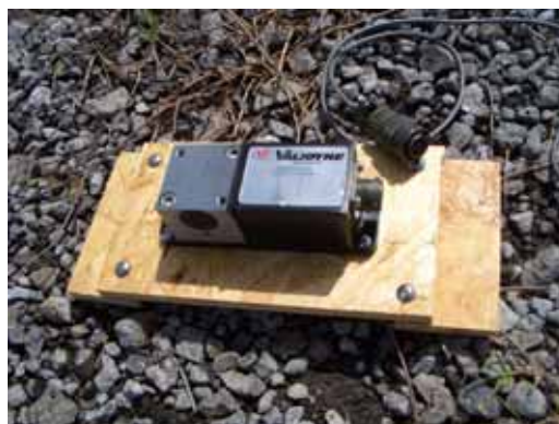
図 2-13 孔内ガス圧測定に使用した微差圧計 P55D
