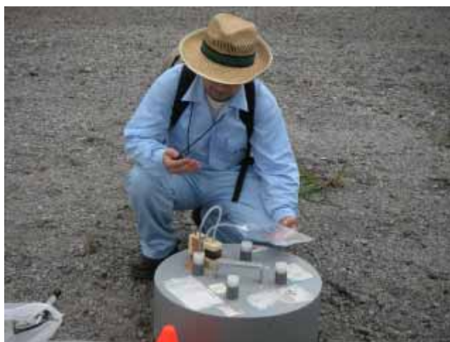
図 2-10 閉鎖型チャンバー法による地表面ガスフラックスの測定状況
