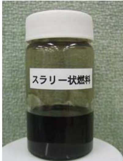
資料写真 2.2-1 スラリー状燃料（石綿含有建材（微粉碎品）＋再生B重油）
