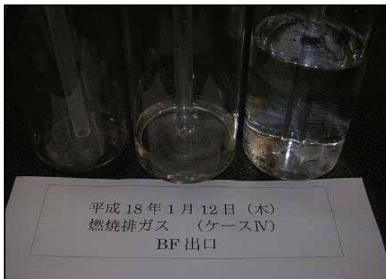
インピンジャーの状況 （ケース ・BF出口燃焼排ガス）
