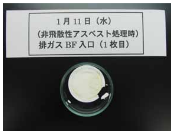
フィルターの状況 (ケース1・BF入口燃焼排ガス)
