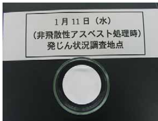
フィルターの状況 (ケース1・発じん状況調査)
