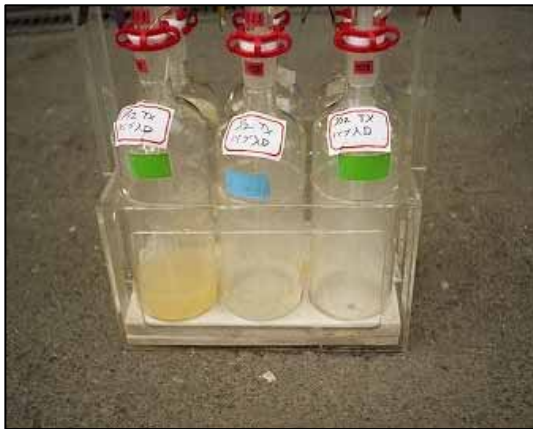
インピンジャーの状況 （ケース ・BF入口燃焼排ガス）
