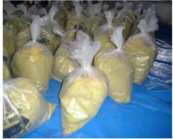
処理対象物 （ケース2・アスベスト含有吹付け材）
