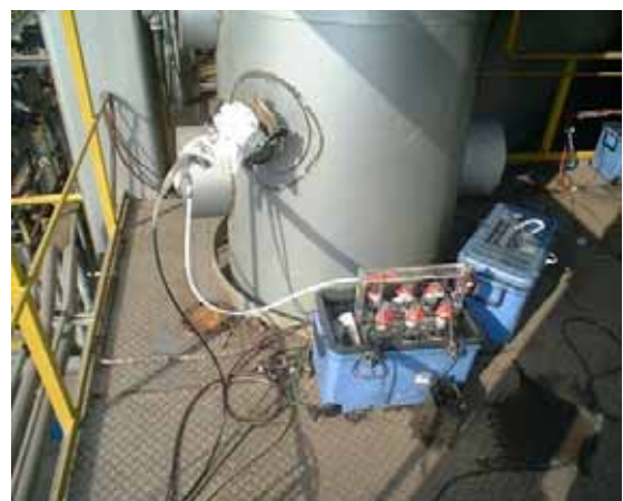
サンプリング状況 （ケース1・BF出口燃焼排ガス）
