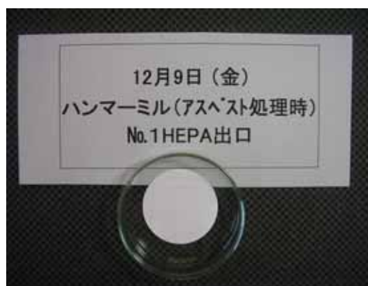
ハンマーミル：フィルターの状況 (ケース1・HEPA出口破碎ガス)
