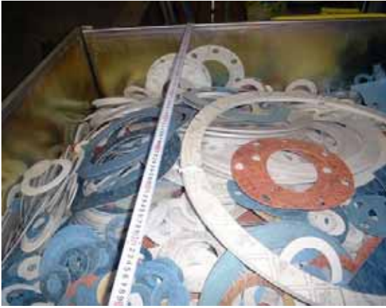
処理対象物 (アスベスト含有シートパッキン)
