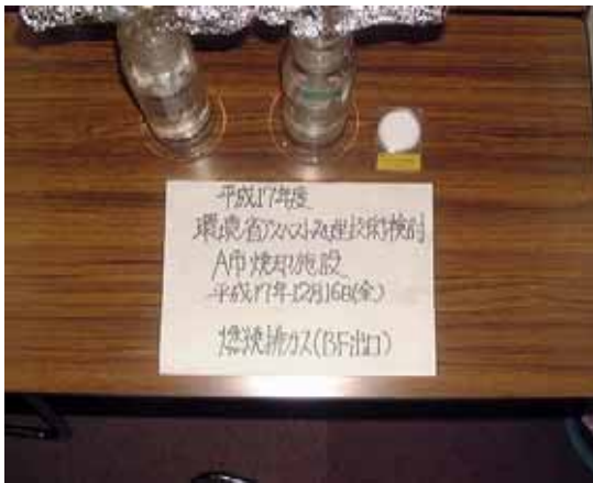
インピンジャー・フィルターの状況 (ケース1・BF出口燃焼排ガス)
