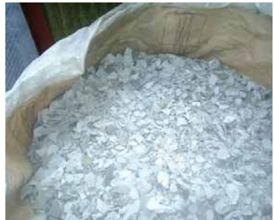
二軸破砕機 : アスベスト含有スレート ( ケース 1 ) [ 破砕物 ]
