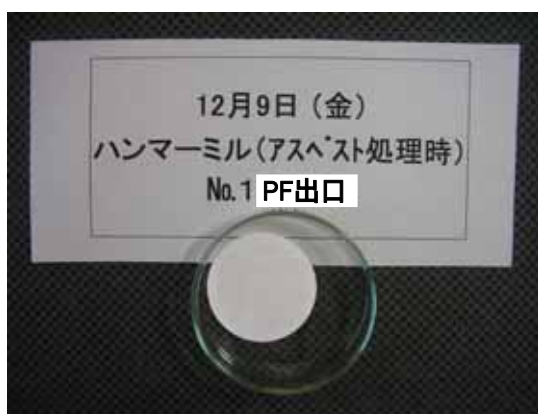
ハンマーミル：フィルターの状況 (ケース1・PF出口破碎ガス)
