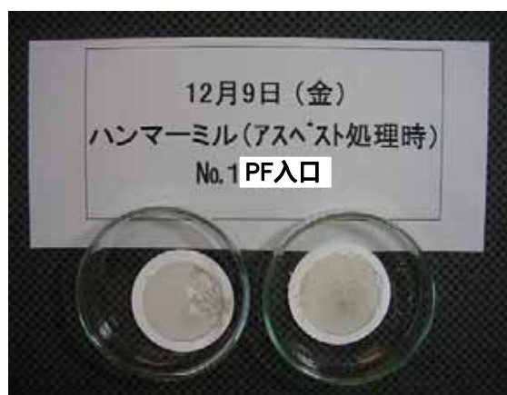
ハンマーミル：フィルターの状況 (ケース1・PF入口破碎ガス)
