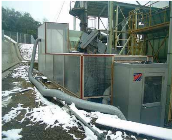
二軸破砕機 ( 囲い状況 )
