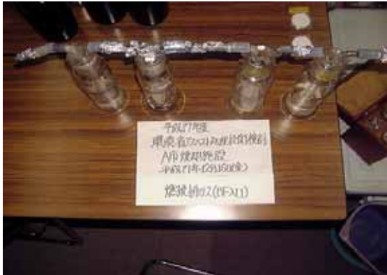
インピンジャーの状況 (ケース1・BF入口燃焼排ガス)
