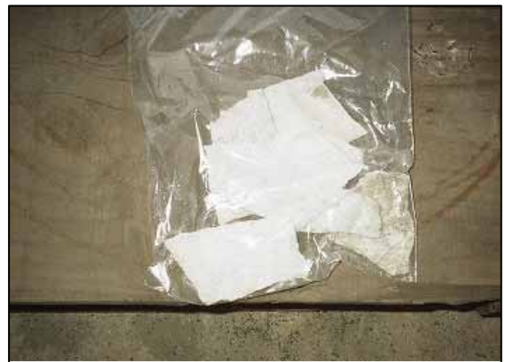
処理対象物 (アスベスト含有スレート)
