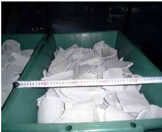
二軸破砕機 : アスベスト含有スレート ( ケース 1 ) [ 処理前廃棄物 ]
