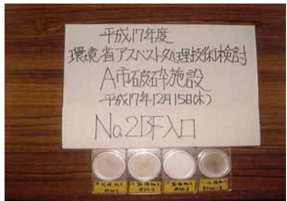
フィルターの状況 (ケース1・No.2BF入口破碎ガス)
