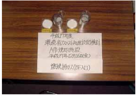
フィルターの状況 (ケース1・BF入口燃焼排ガス)
