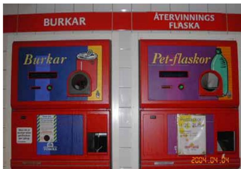
缶の回収機 (左) とペットボトルの回収機 (右)
