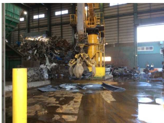
図 1-10 ロードラーでシュレッダーに投入
