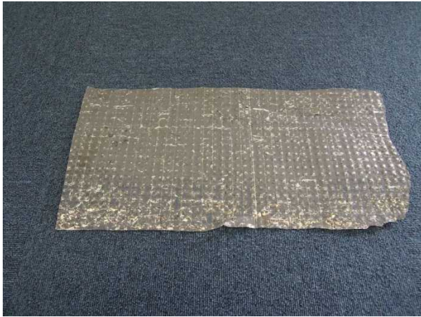
図 1-27 破砕機投入後のモジュール
