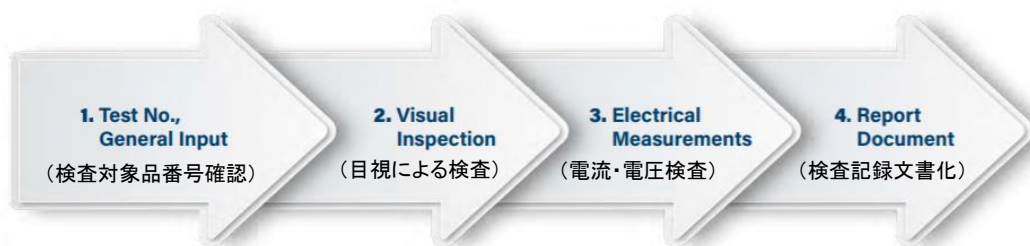
図 3.1-2 モジュールの再利用に備えるための検査手順の例
