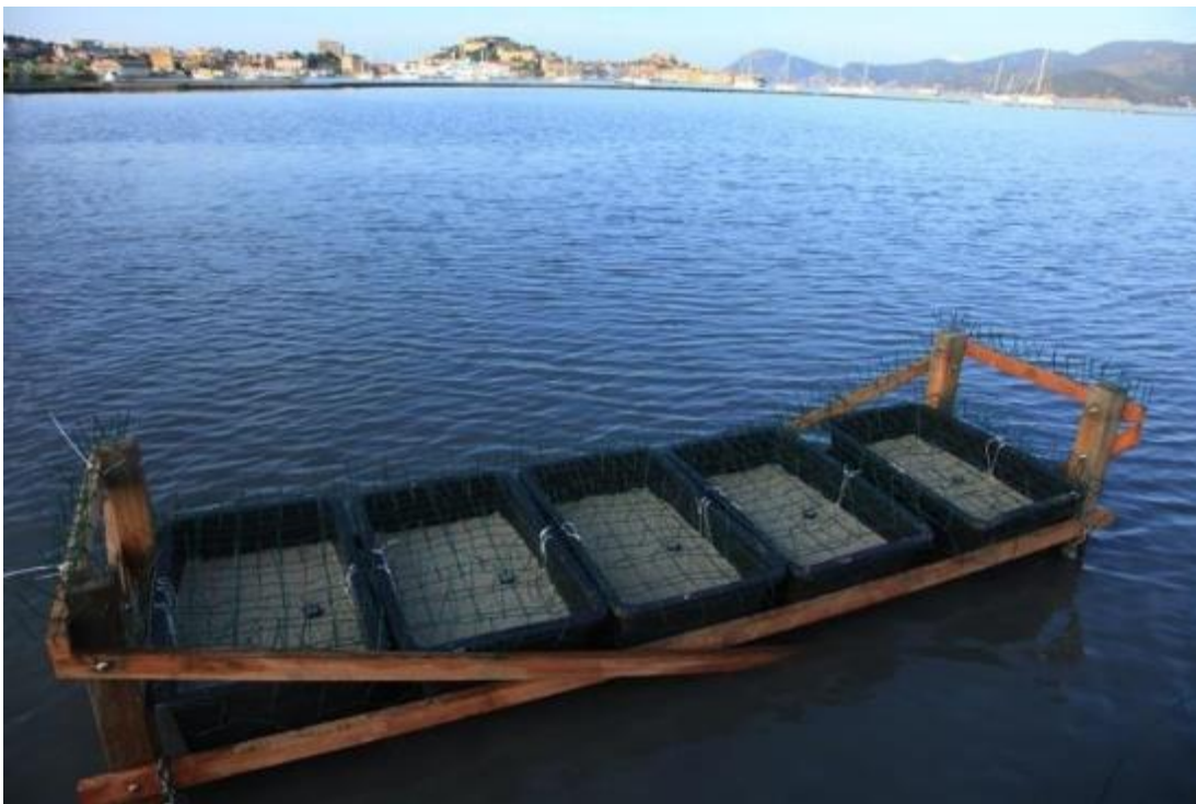
図 2 1 海岸で浮いているプラスチックを想定した際の生分解性試験
