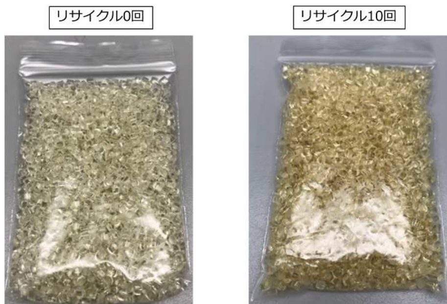
図 4-7 セルロース樹脂 リサイクル品のペレット外観
