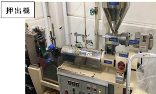
図 4-4 リサイクル性の確認に用いた粉碎機（上）、および1軸押出機（下）
