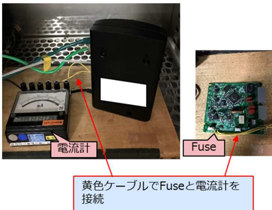
図 5-7 消費電力測定の様子
