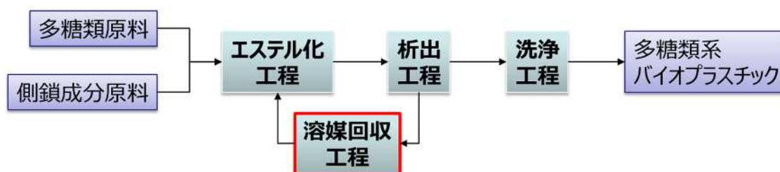
図 3-1 多糖類系バイオプラスチックの誘導体化プロセス
