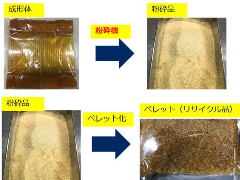
図 5-8 セルロース樹脂のリサイクル工程（粉砕～ペレット化）
