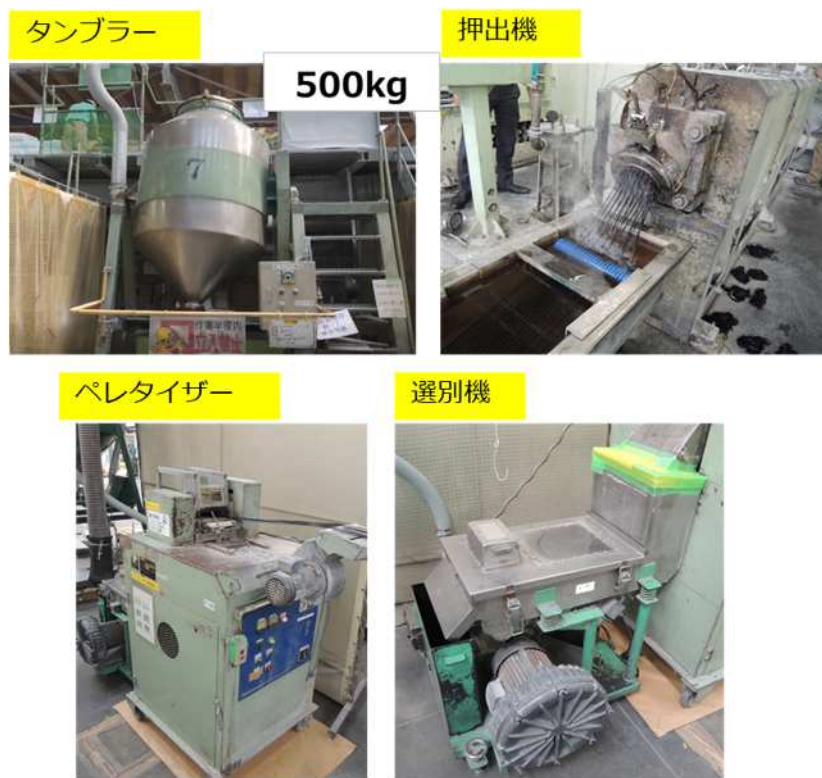
図 5-4 ペレット化 生産工程設備（大型機）
