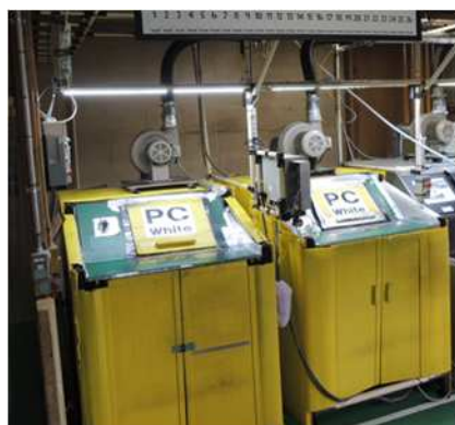
図 5-9 粉砕機の外観写真
