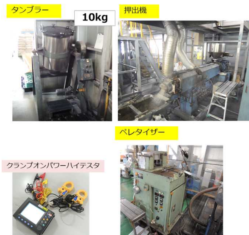
図5-2 ペレット化 生産工程設備（小型機）
