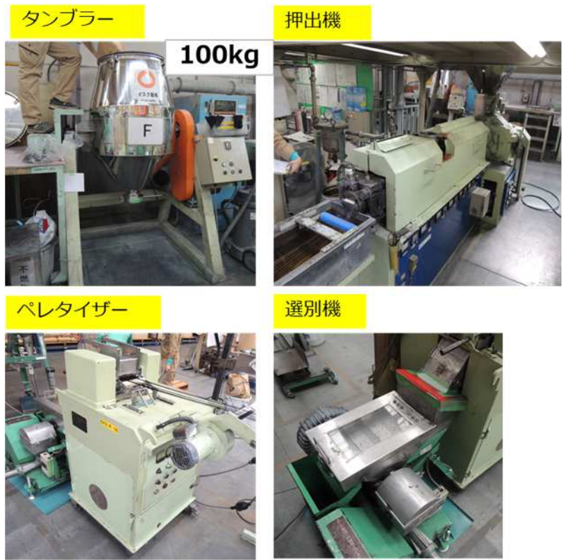
図 5-3 ペレット化 生産工程設備（中型機）
