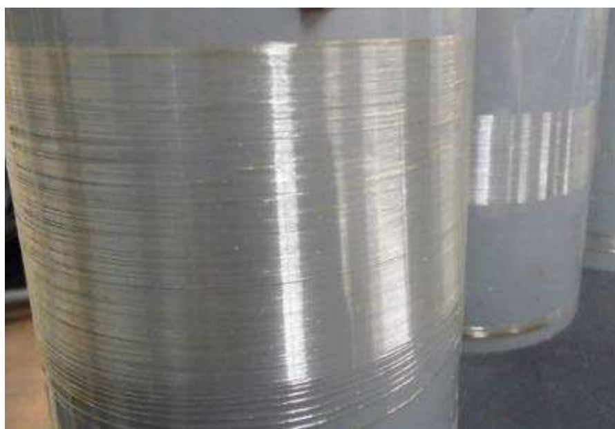
図 1-17 パラミロンエステルの熔融紡糸繊維
