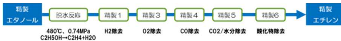
図2 - 1 - 1 - 2 - 1 エチレンサンプル製造フロー
