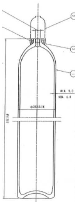
図2 - 1 - 1 - 2 - 2 エチレン充填ボンベ（47L）
