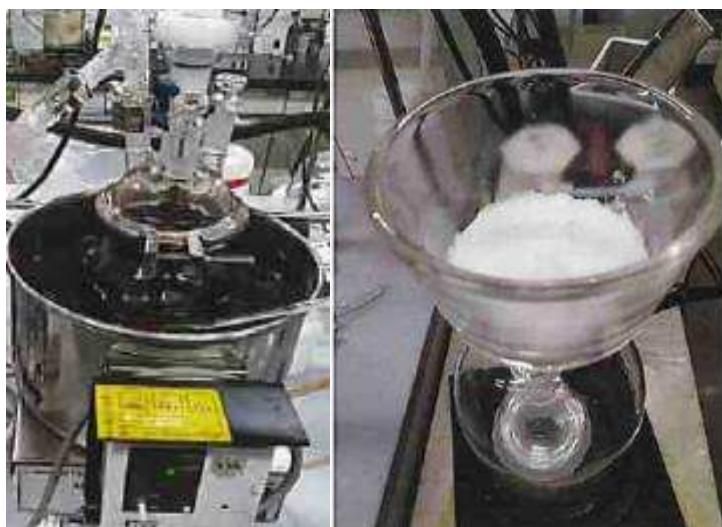
写真 2 - 2 - 3 - 1 a - 1 乳酸脱水 - オリゴマー合成 - ラクチド化状況 （左：オリゴマー、右：精製ラクチド）
