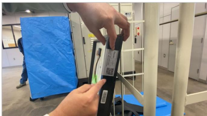
図 3-84 使用済 PV モジュールへのラベル貼付作業の様子
