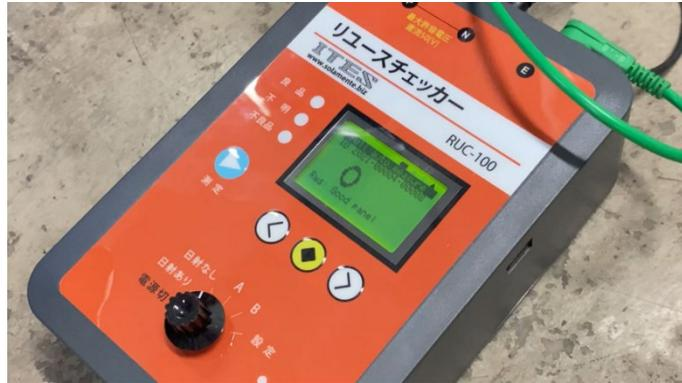
図 3-90 リユースチェッカーによる簡易検査の様子③
