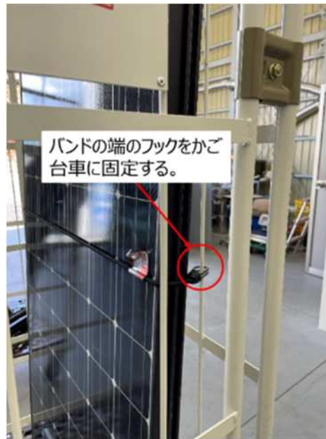
図 III-19 伸縮性のバンドを用いた太陽光パネルのかご台車への固定
