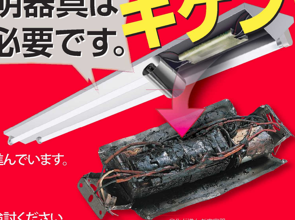
劣化が進んだ安定器
