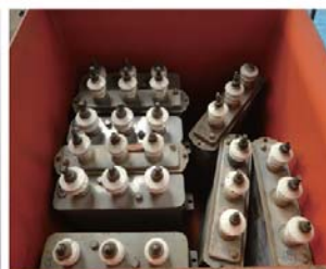
鋼製容器への収納例
