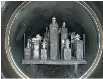
(紙を絶縁紙に使用した コンデンサの処理後)
