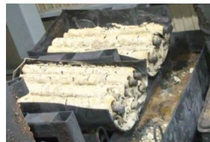
加熱処理後の状況 表面がよく焼けている
