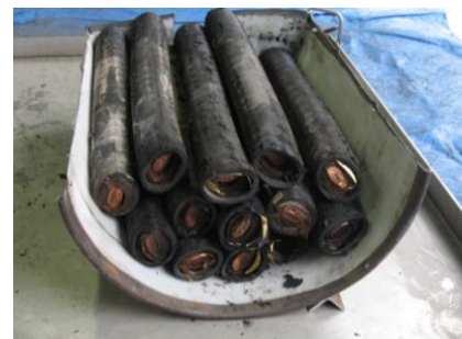
半割したドラム缶上にOFケーブルを積載
