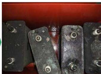
液漏れ機器を収納した容器内の状態。底面に油溜まり、機器に黒い油埃が付着。処理施設内で、そのまま容器を開蓋すると、PCBにより作業環境が悪化。
