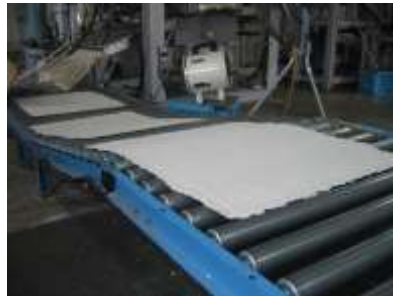
図 5-3 パルプシート製造工程
