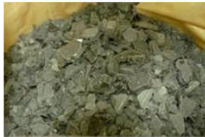
図7 乾式精製済みパネル硝子
