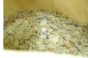
図6 乾式精製済みファンネル硝子
