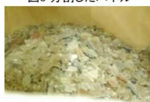
図6 乾式精製済みファンネル硝子
