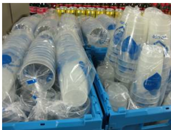
洗浄済みのリユースカップは 10 個ずつピロー包装される
