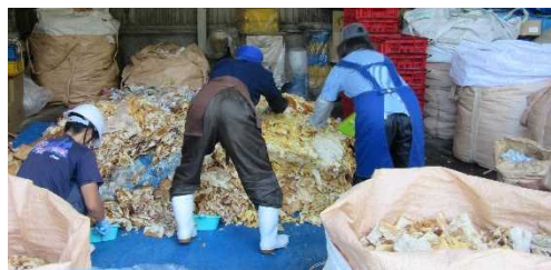
手作業による分別、異物確認
