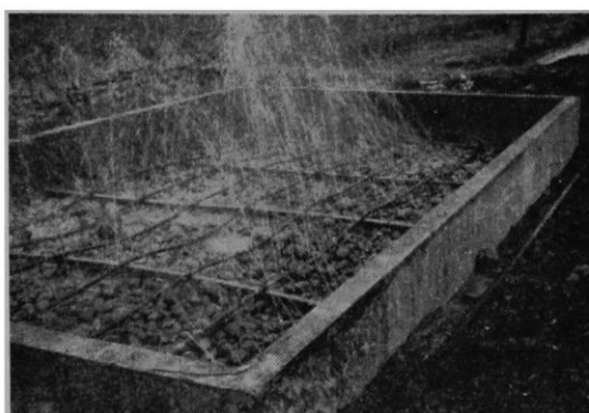
図2.3-9 細霧方式による窒素除去 23)
