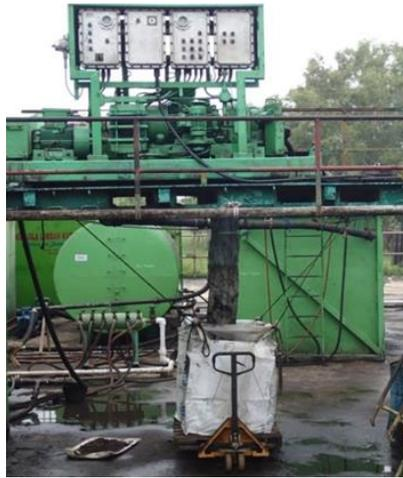
図 3-14 石油スラッジの固液分離装置（デカンター）
