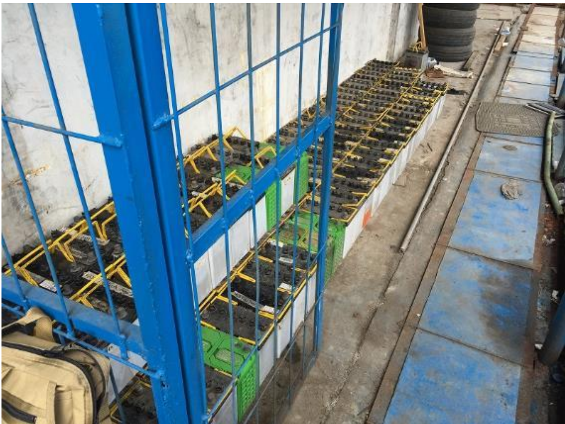
図 3-9 J プールの整備工場における廃鉛バッテリー保管状況
