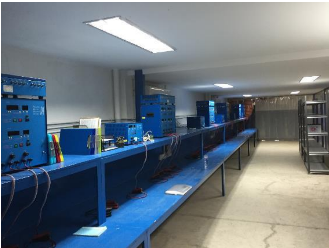
図 8-2 鉛バッテリー再生ライン
