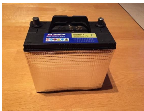
断熱対策した鉛バッテリーの状態
