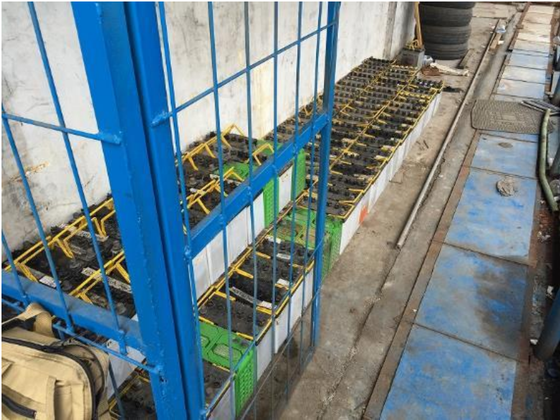
図 3-8 G プールの整備工場における廃鉛バッテリー保管状況
