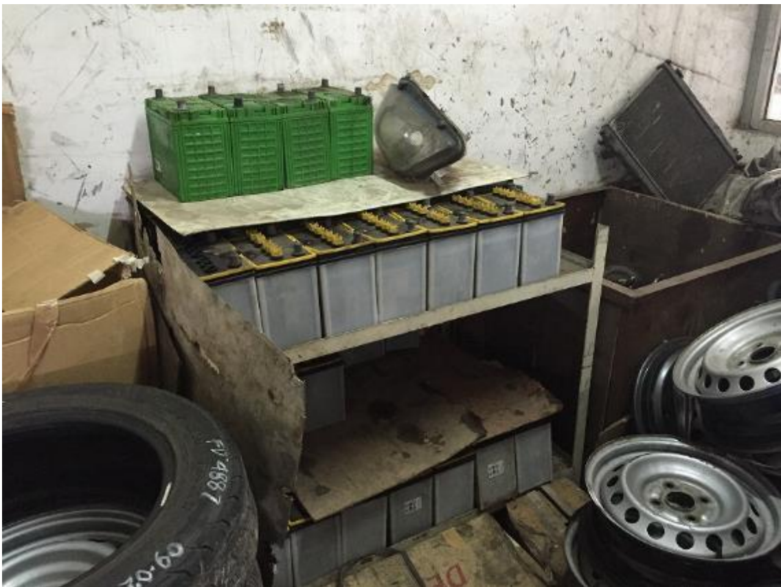
図 3-7 F プールの整備工場における廃鉛バッテリー保管状況
