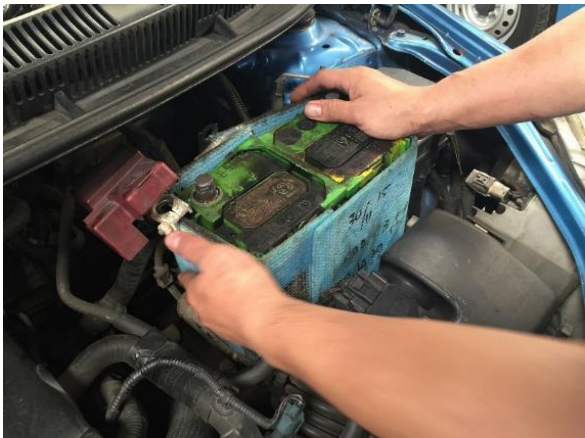
図 7-4 再生鉛バッテリーを搭載した PT. Blue Bird 保有の Limo (その 1)
