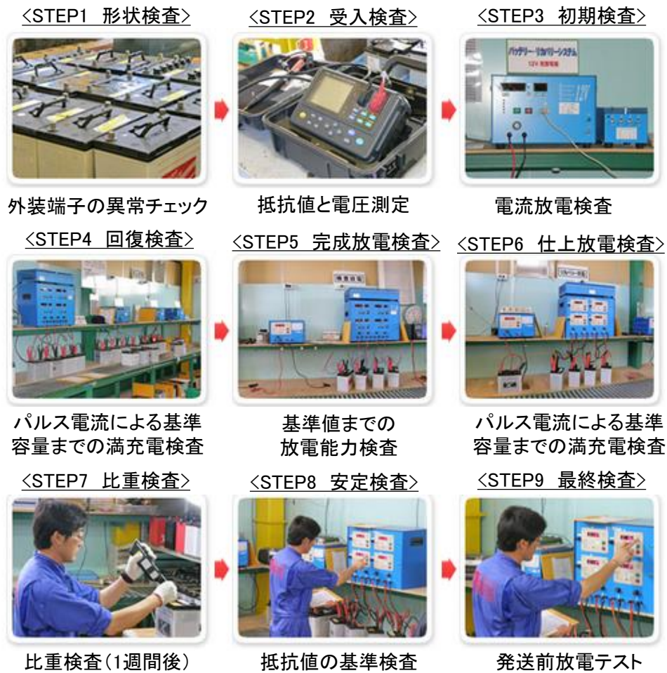
図 1-2 ABRs による使用済み自動車用鉛バッテリーの再生手順
