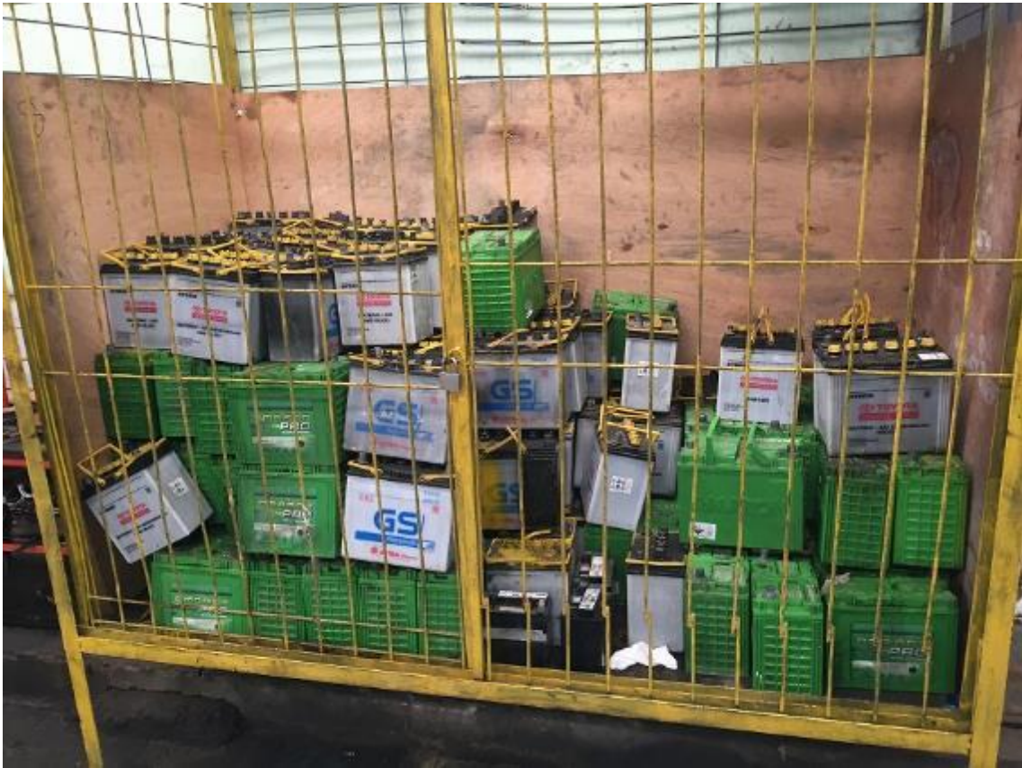
図 3-2 B プールの整備工場における廃鉛バッテリー保管状況
