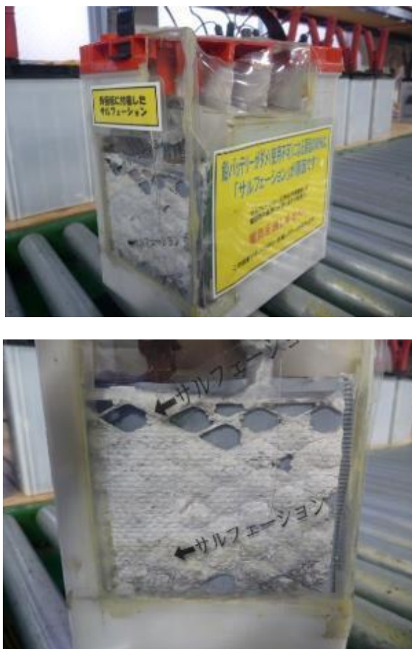
図 1-1 バッテリーに付着したサルフェーション
