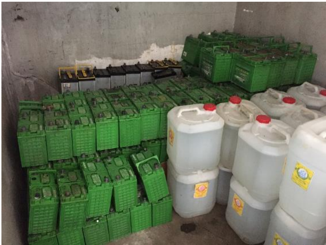
図 3-11 Nプールの整備工場における廃鉛バッテリー保管状況
