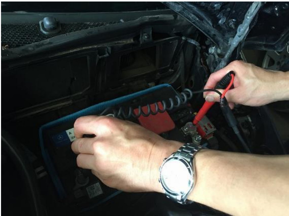
図 7-6 PT. Blue Bird 保有の Limo に搭載した再生鉛バッテリーのチェック風景
