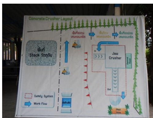
写真 4-7. 再生骨材プラント（L）のレイアウト図
