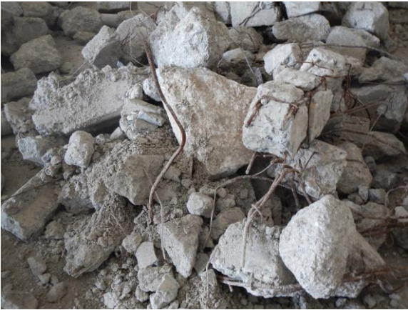
写真 4-1. 原料として利用されるコンクリート廃材
