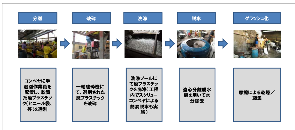
図表 4-3 民間企業 MRF モデルのグラッシュ製造プロセス
